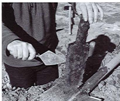
Abb. 4: Hölzerner Tonabstreicher eines Zieglers. Foto: T. Trebeß.
